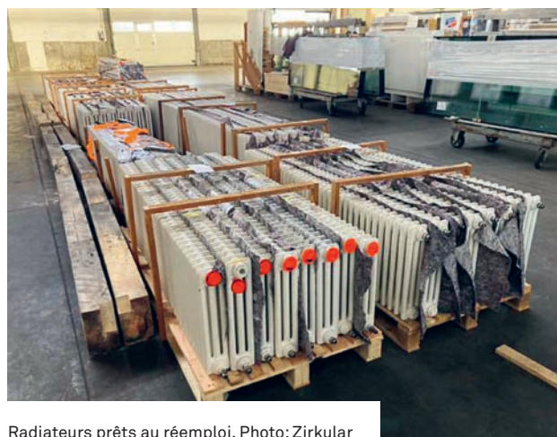
Radiateurs prêts au réemploi. Photo: Zirkular
