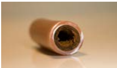
Conduite de chauffage au sol fragilisée et encrassée.
