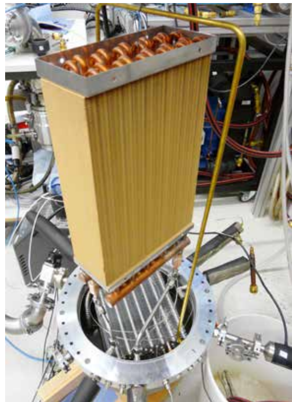
Echangeur de chaleur à adsorption testé à l'Institut for Solar Technologies de wla HSR de Rapperswil, en collaboration avec IBM Research Zurich. © SPF Rapperswil/IBM Research
