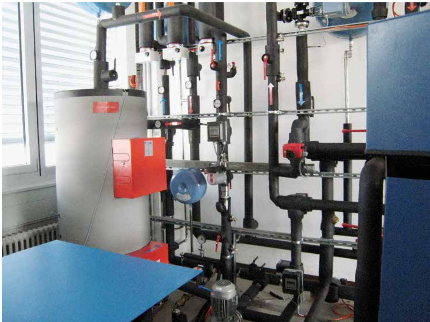
Infrastructure thermohydraulique pour tester la capacité d'adsorption d'unités de pompes à chaleur d'une capacité de refroidissement allant jusqu'à 10 kW. Une capacité de chauffage de 30 kW sera testée dans le cadre du projet THRIVE. © HEIG-VD
