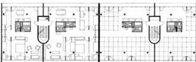
métalliques, toutes amovibles, séparant les pièces. La grille devient la trame de la façade, rythmée par la répétition d'un même module de fenêtre verticale, encadrée par des murs et des dalles en béton, une image abstraite et épurée qui semble en attente des décorations spontanées des habitants...
